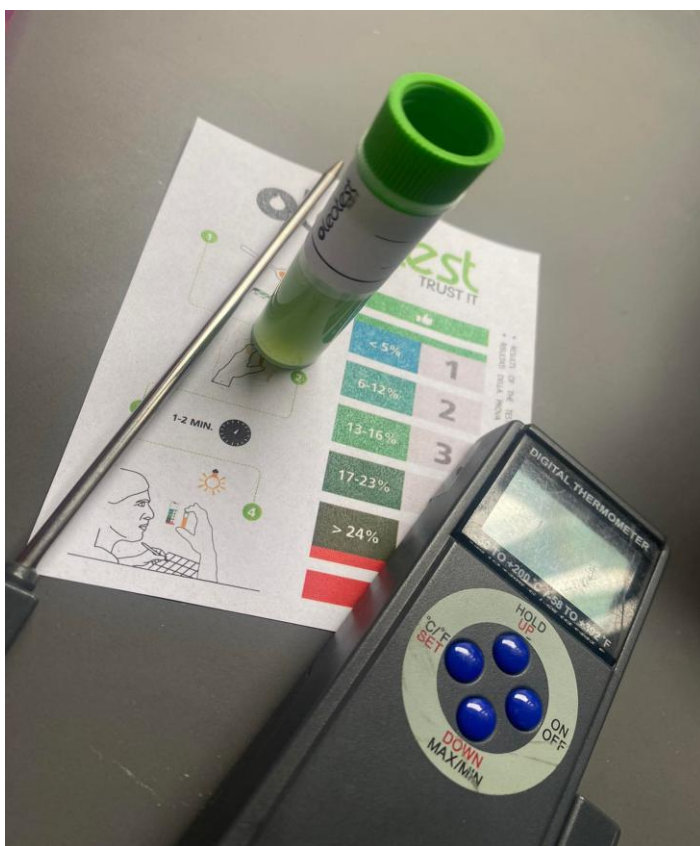
Fot. Oleotest wykonany w trakcie kontroli jakości zdrowotnej tłuszczu smaźalniczych (źródło: zasoby własne PSSE w Rzeszowie)
